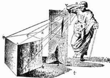
FIG. 7. En esta ilustración del libro de BROOK TAYLOR, *New Principles of Linear Perspective*, Londres, 1749, se muestra el principio básico de la perspectiva lineal: la sección de la pirámide visual cuyo vértice está en el ojo del observador, O. La pirámide, en este caso, se apoya en los vértices de un cubo. En el plano del cuadro se representa dicha sección que es la perspectiva.
