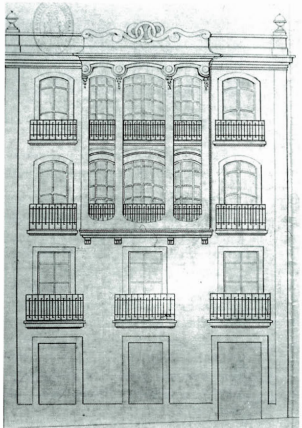
Fig. 4. Vivienda en la Plaza de las Mercedes con galería de madera. Dibujo del arquitecto. 1917.
