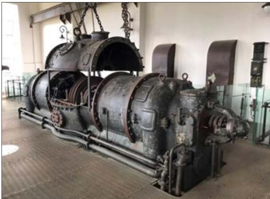
Sala de turbinas. Una de las dos turbinas de vapor, tipo “Ljungström”, construidas por ASEA (Allmänna Svenska Elektriska Aktiebolaget), Compañía General Eléctrica Sueca, de 3 MW.
